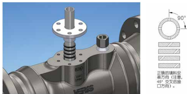
图 4: 密封填料安装
